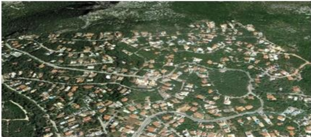
Εικόνα 3. Δομημένη περιοχή που κατά το παρελθόν έχει αναπτυχθεί εντός δάσους ή δασικής έκτασης και τα κτίσματα που την συγκροτούν έχουν μεγάλη εγγύτητα με καύσιμα δασικής προέλευσης.
